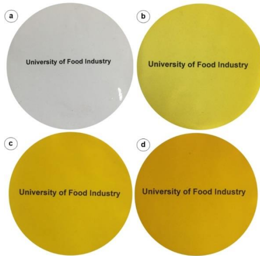
Hình 1 Ảnh màng a) PDA, b) PDA-AgNPs-0,2, c) PDA-AgNPs-0,4 và d) PDA-AgNPs-0,6
