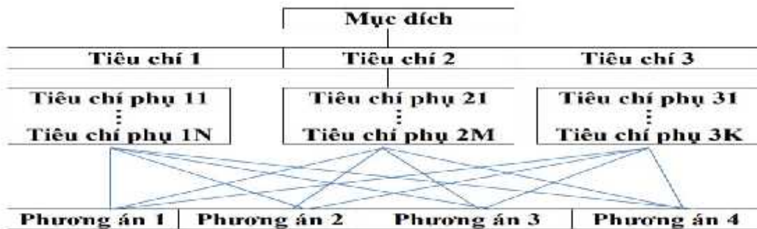
Hình 1.2. Mô hình chung về cây phân cấp thứ bậc AHP (a), các tiêu chí chính (criteria), các tiêu chí phụ (sub-criteria) và các phương án lựa chọn/ đánh giá (alternatives). Cấu trúc và nghiên cứu điển hình
