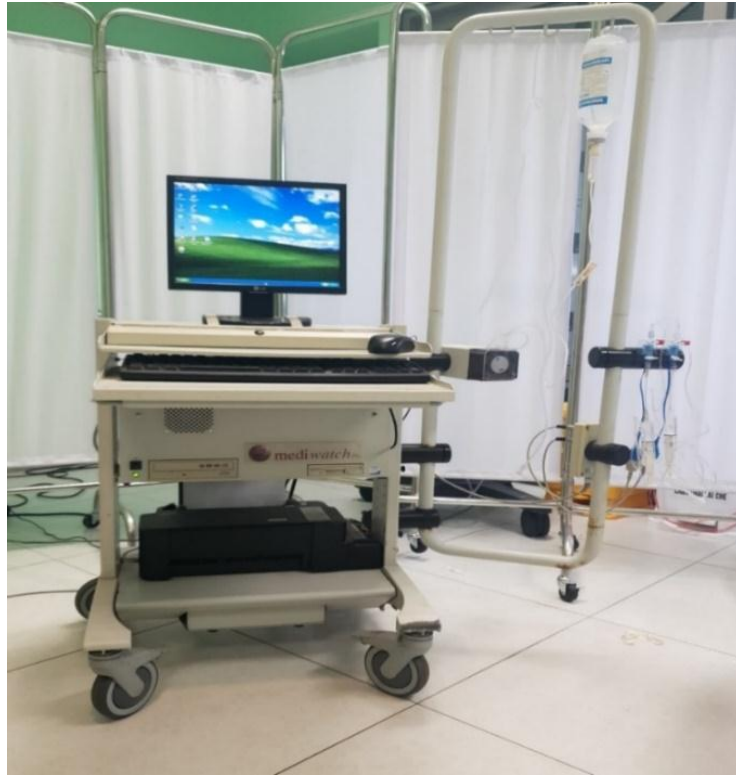
Hình 2.2. Máy niệu động học (màn hình, bơm áp lực, bộ phận cảm biến) mediwatch, version 9.2, United Kingdom
