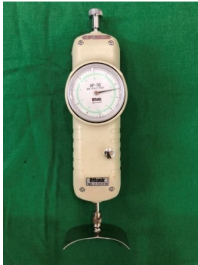
Ảnh 2.5. Dụng cụ đo lực cơ tam đầu và đánh giá cảm giác
