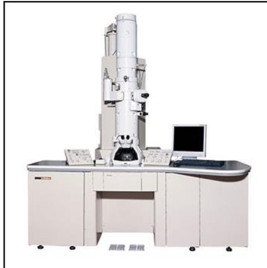
Hình 2.4. Kính hiển vi điện tử truyền qua JEOL – 1011 tại Viện 69 – Bộ tư lệnh bảo vệ Lăng Chủ tịch Hồ Chí Minh
