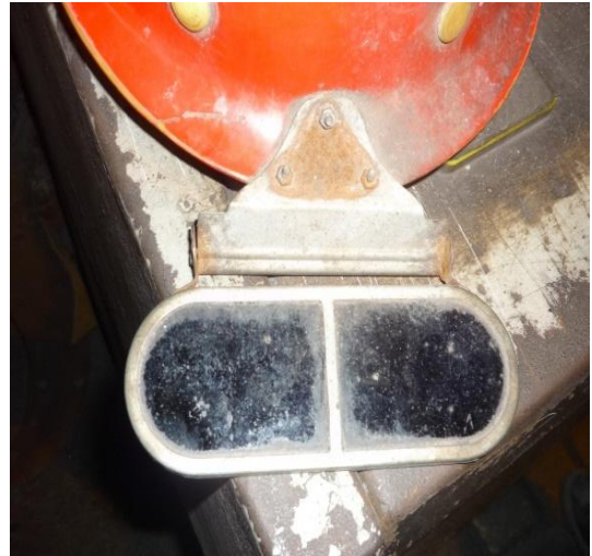
Ảnh 3.1. Mũ, kính bảo hộ của công nhân luyện thép sử dụng bị mờ ố
