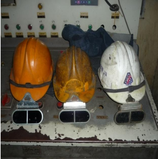
Ảnh 3.1. Mũ, kính bảo hộ của công nhân luyện thép sử dụng bị mờ ố
