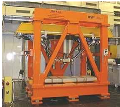
Hình 1.7. Máy phay hai cấu trúc song song - Dự án Hexaglide [3]
