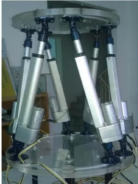
Hình 4.3. Mô hình c k h í tay máy song song ki u Stewart–Gough Platform
