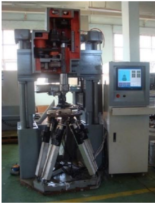
Hình 1.16. Hình th ng gia công 5 tr c o CNC+Hexapod [110]
