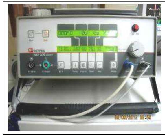
Hình 2.4. Máy phát năng lượng sóng có tần số radio
