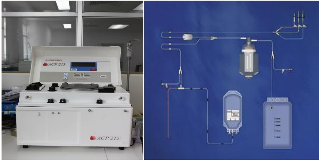
Hình 2.1. Máy ACP215 Hình 2.2. Sơ đồ lắp ráp bộ Kit vào máy ACP215
