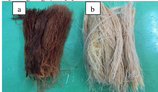
Hình 13. Sợi NFFS: xử lý Na 2 S (a) và tẩy trắng bằng H 2 O 2 (b)
