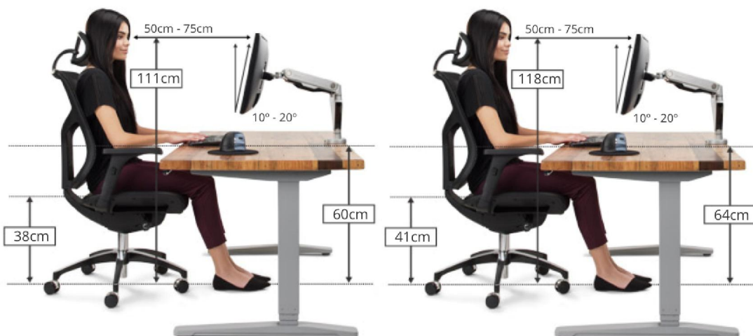
Hình 1.36. Kích cỡ bàn và ghế gợi ý cho người cao 1,6m (trái) và 1,7m (phải)
