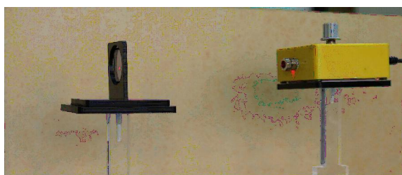
Hình 8. TN xác định mật độ điểm ảnh sử dụng cách tử truyền qua
