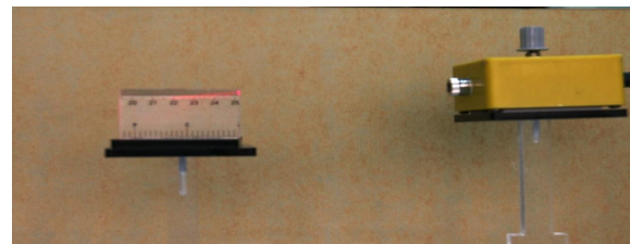
Hình 2. TN xác định bước sóng của tia laser bằng cách tử nhiễu xạ
