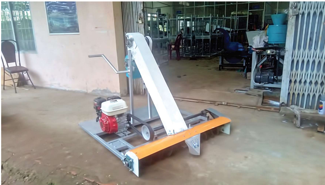
Hình 4. Máy thu gom đánh toi phân tròn quế đã được chế tạo.
