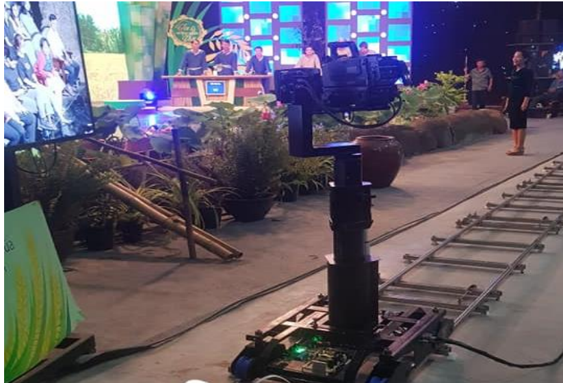
Hình 10. Hệ thống Robot được vận hành thử nghiệm tại trường quay Trung tâm THVN Khu vực Nam Bộ
