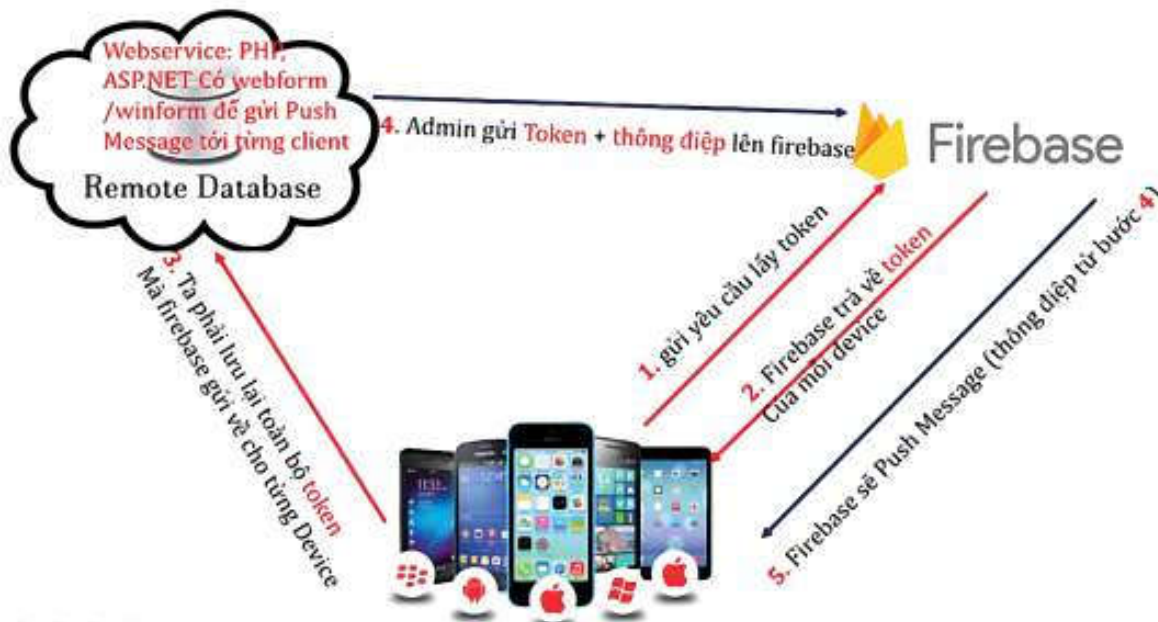
Hình 1. Quy trình hoạt động của FCM
