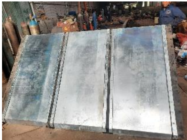
Hình 9: Hình ảnh chế tạo kết cấu chống tràn dạng bản chống thực tế/03 mô đun sau khi lắp ghép
