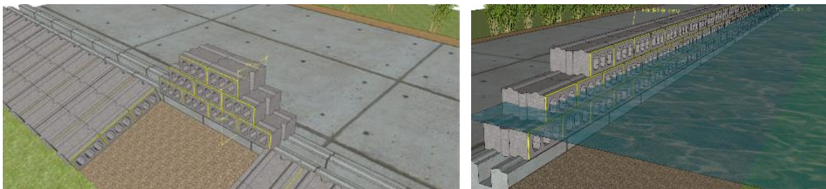
Hình 13: Cách xếp tường với cột nước tràn dưới 1,0m
