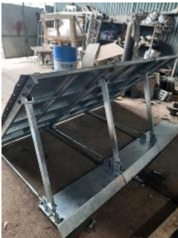
Hình 9: Hình ảnh chế tạo kết cấu chống tràn dạng bản chống thực tế/03 mô đun sau khi lắp ghép
