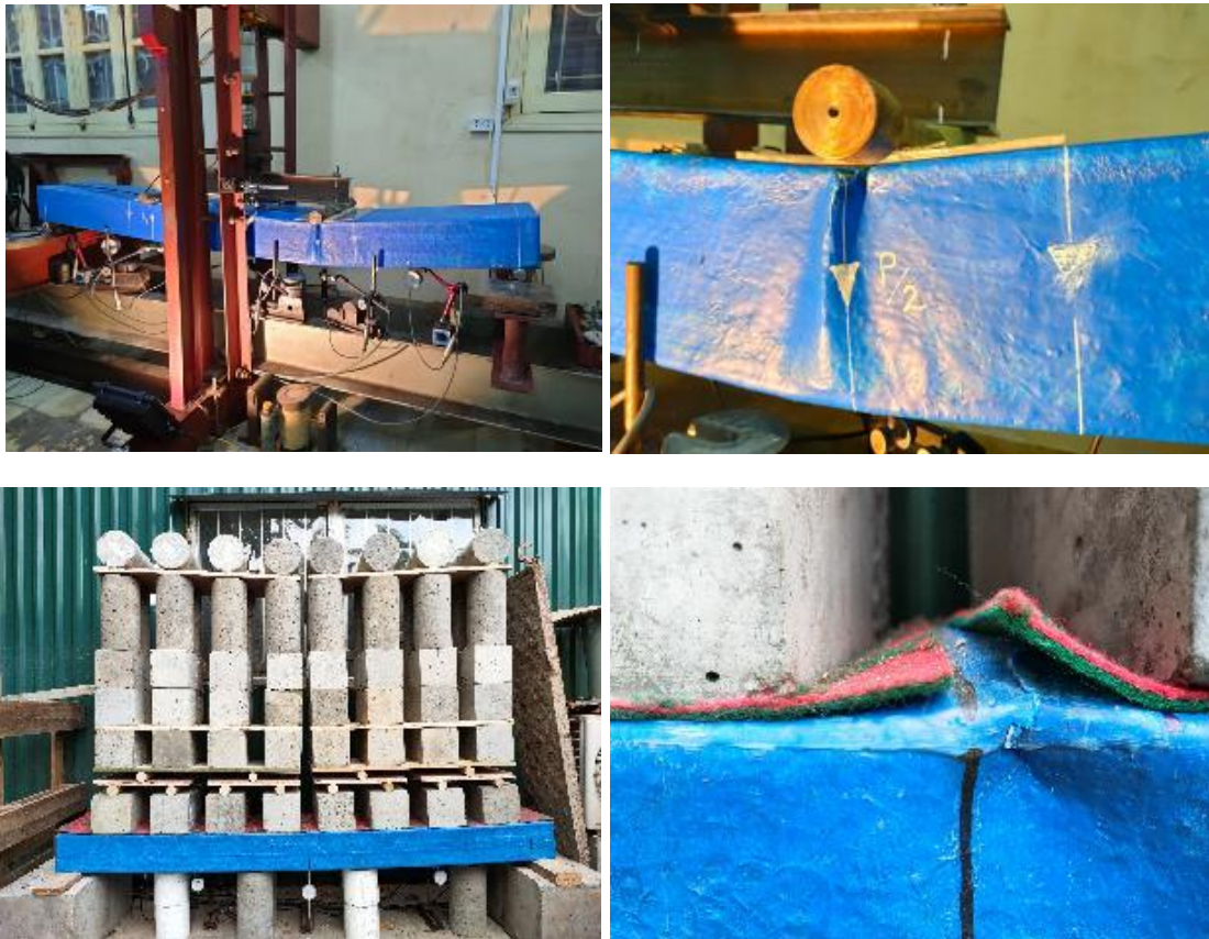
Hình 4: Thí nghiệm tải trọng tĩnh xác định khả năng chịu tải của tấm phai
