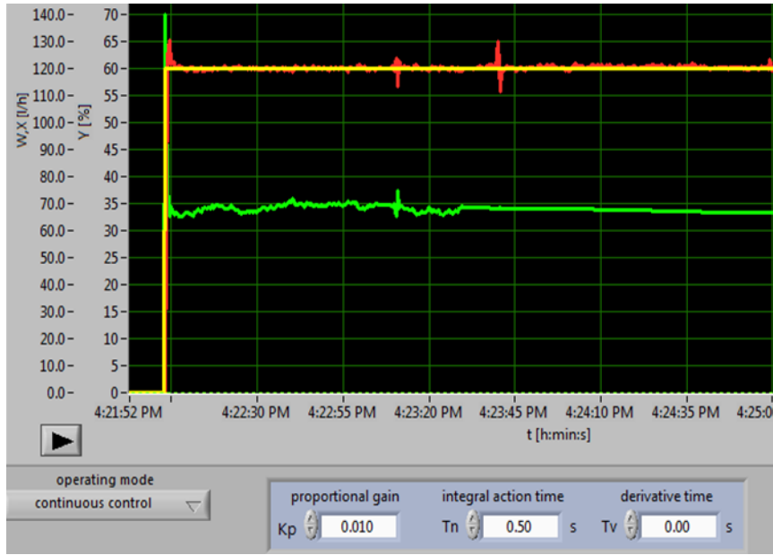
Hình 4: Kết quả điều khiển PI hệ RT20 trên phần mềm Gunt
