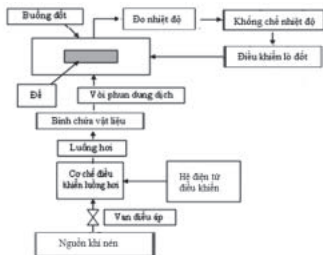
Hình 1. Sơ đồ khối hệ tạo màng bằng phương pháp phun nhiệt phân.
