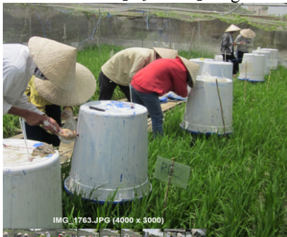
Hình 1: Thí nghiệm đo phát thải khí CH 4 và N 2 O trên lúa trồng trên thảm kế tại nông trại khu 2- Trường Đại học Cần Thơ, diện tích mỗi lô thảm kế là 2x2m 2
