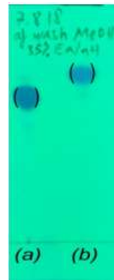
Làm sạch chất rắn bằng dung môi metanol ng Sắc ký bản mỏng sau xử lý qua metanol ng. Vết (a) phenothiazine, (b) chất rắn sau xử lý
