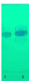
Sắc ký bản mỏng sau xử lý qua metanol ng. Vết (1) phenothiazine, (2) chất rắn sau xử lý
