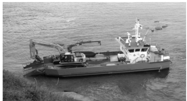
Hình 2. Tàu chuyên dụng đang vận chuyển máy cẩu lên bờ
