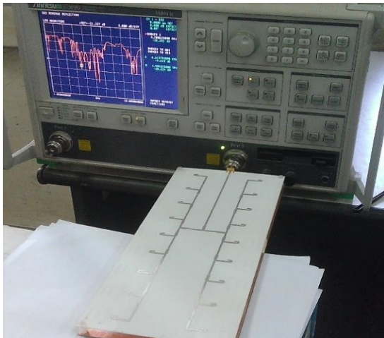
Hình 7. Hình ảnh đo anten mảng bằng máy VNA
