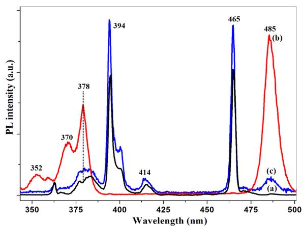
**Figure 2.** PLE spectra of: (a) Eu<sup>3+</sup> in YAB:Eu<sup>3+</sup>, (b) Tb<sup>3+</sup> in YAB:Eu<sup>3+</sup>, and Eu<sup>3+</sup> in YAB:Tb<sup>3+</sup>, Eu<sup>3+</sup>
