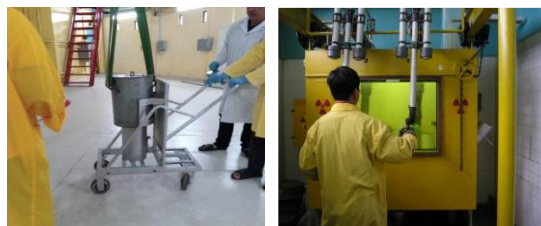
Hình 4. Vận chuyển mẫu từ lò phản ứng đến box mở mẫu (a) và mở mẫu (b)
