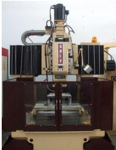
Hình 2. Máy chuyên dùng SPIF 2 trụ dùng trong thực nghiệm
