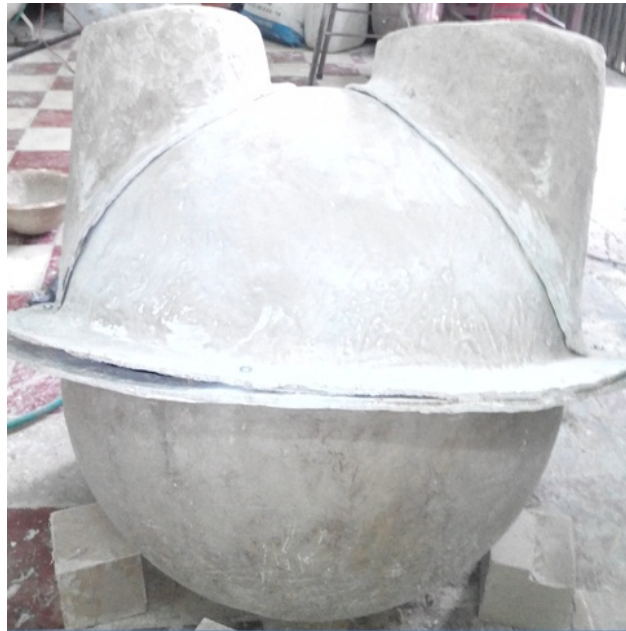
Hình 7: Hàm ủ biogas composite gia công từ tấm mat sợi xơ dừa
