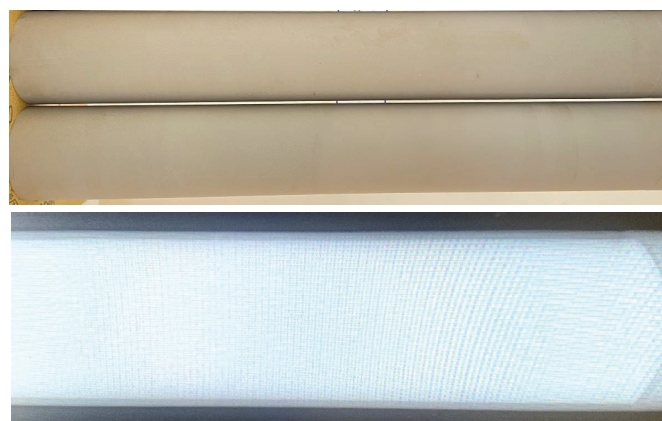
Hình 5. Kết quả chụp X-quang thổi nhiên liệu sau khi phủ chống cháy.
