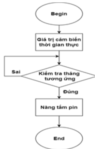
Hình 11: Lưu đồ thuật toán điều khiển hoạt động của động cơ 2.
