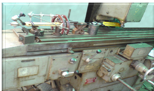
Ảnh 2.4 Thí nghiệm đánh giá khả năng cố định ổ gãy của khung CĐN dưới tác động của lực ép dọc theo trục xương
