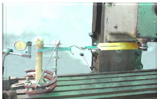
Ảnh 2.2. Thí nghiệm đánh giá khả năng cố định ổ gãy của khung CĐN dưới tác động của lực uốn.
