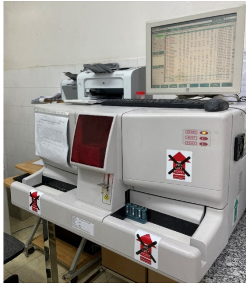
Ảnh 2.2. Máy phân tích huyết học tự động - Máy xét nghiệm IL-17A và hs-CRP
