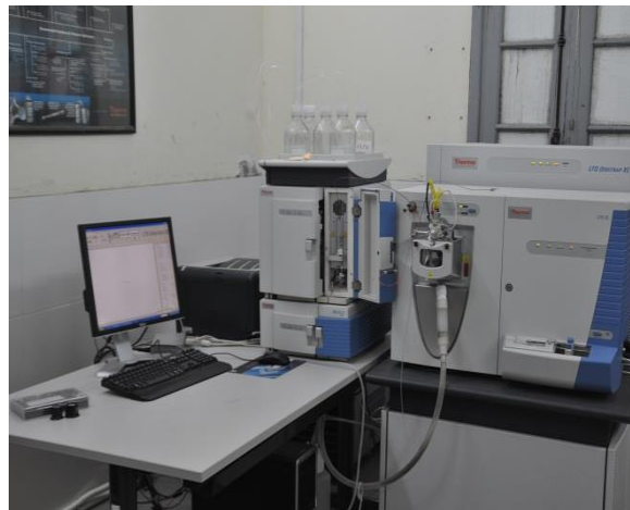
Máy sắc ký lỏng khối phổ LC ESI Orbitrap (Thermo LTQ Orbitrap XL), Phòng NC Trọng điểm hóa học, ĐHQG HN
