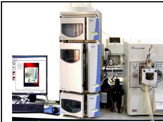
Máy sắc ký lỏng khối phổ (LC – MS/MS) Thermo Finigan LCQ Advantage Max, detector PDA và MS/MS, V.KNT.TU
