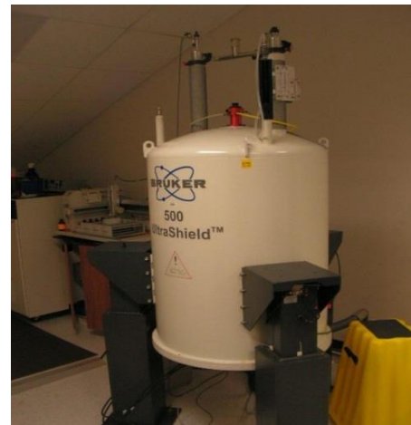
Thiết bị cộng hưởng từ hạt nhân Bruker Avance AM500FT- NMR BioSpin NMR, Viện Hóa học, V.KH&CN VN
