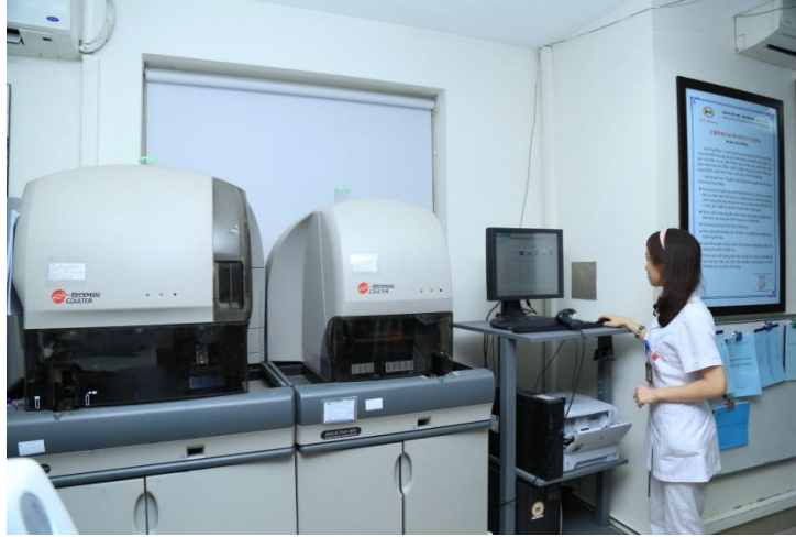
Hình 2.5. Hệ thống máy đếm tế bào tự động Beckman coulter DxH 800, Mỹ
