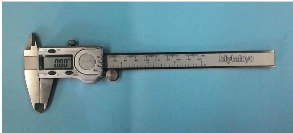
Hình 2.6: Thước đo Mytatoyo, hiển thị kết quả đến 0,01 mm
