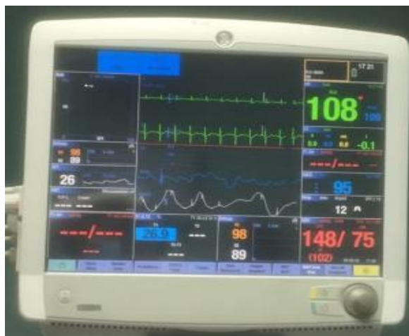
Hình 2.4. Các thông số được hiển thị trên màn hình theo dõi B650
