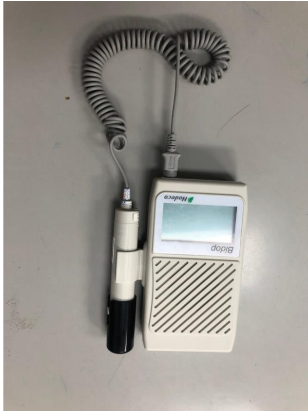
Hình 2.3. Máy siêu âm Doppler cầm tay tần số 5MHz
