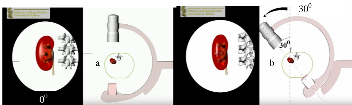
Hình 1.17: Phương pháp tam giác (mặt phẳng thẳng đứng)
