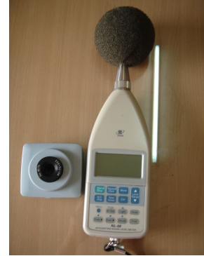
Hình 2: Máy Rion NL-06 của Nhật dùng đo cường độ âm ở từng tần số từ 63 - 8000 Hz.
