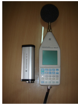
Hình 1: Máy Rion NA-27 của Nhật sản xuất, dùng để chuẩn hóa.
