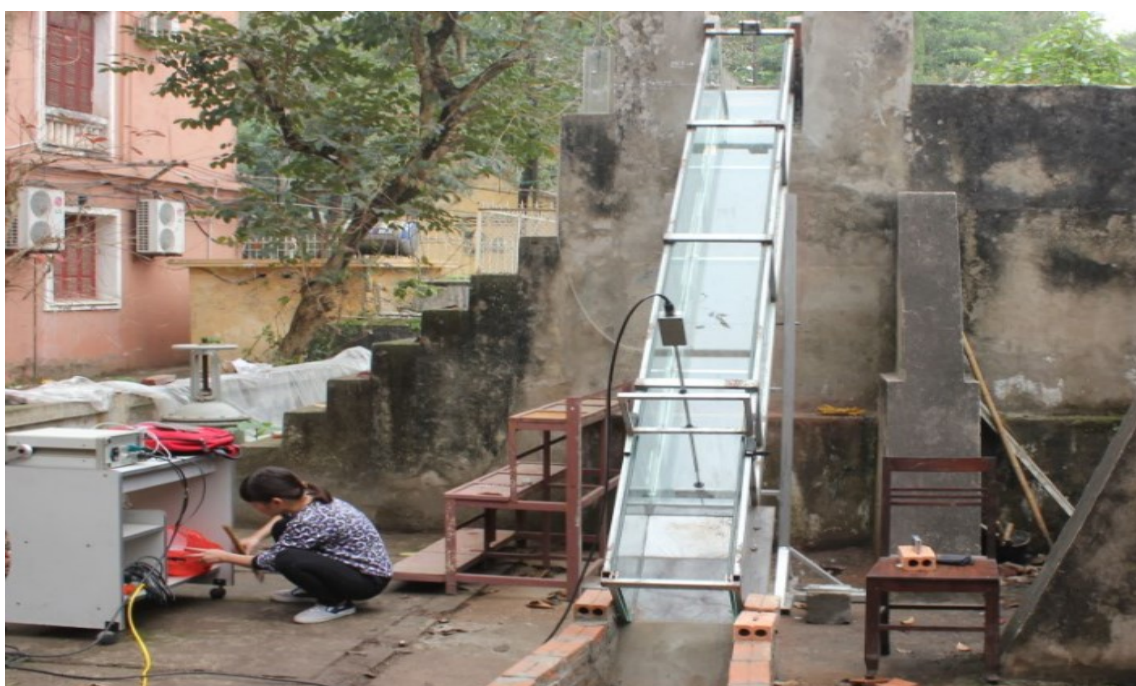
Hình 3. 14. Bố trí thiết bị đo vận tốc dòng chảy trên dốc nước
