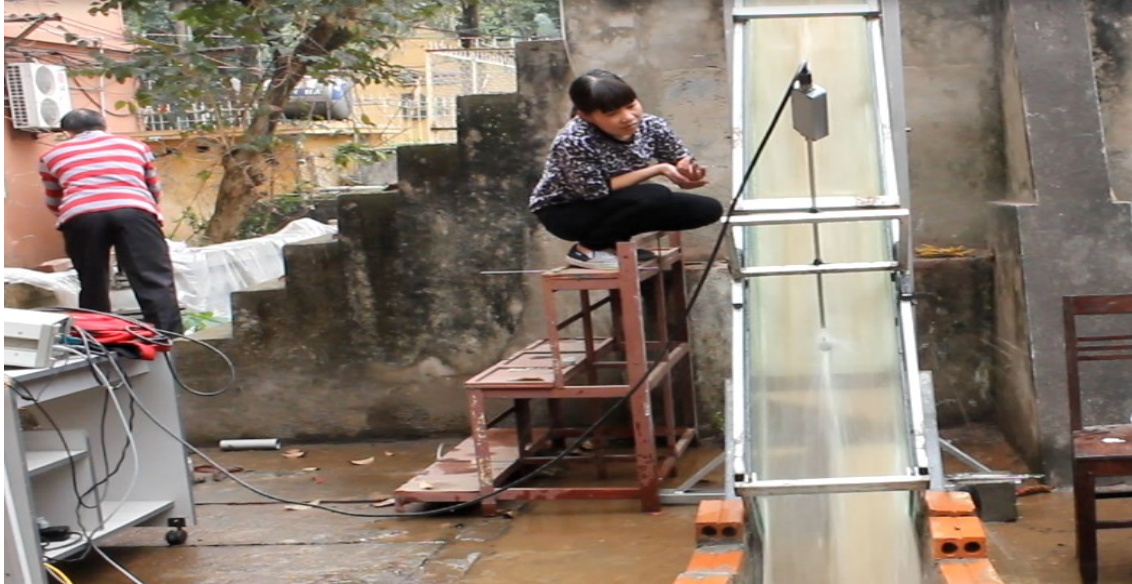
Hình 3. 17. Thí nghiệm đo ứng suất cắt tới hạn \tau_c
