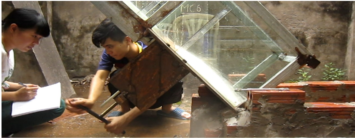
Hình 3. 18. Thí nghiệm đo tốc độ xói
