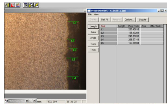
b) Mẫu số 02, \delta_{p.02} = 202,449\mu\text{m} , (phun 3 lớp)
