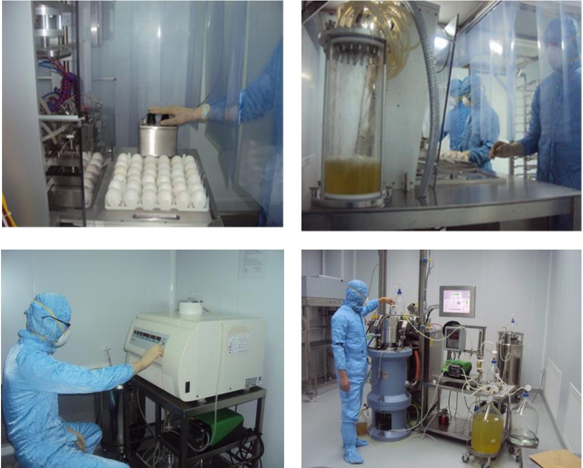
Hình 1. 10. Gây nhiễm và thu hoạch dịch vi rút bằng hệ thống máy Rame-Harte bán tự động công suất 10.000 trứng/giờ
