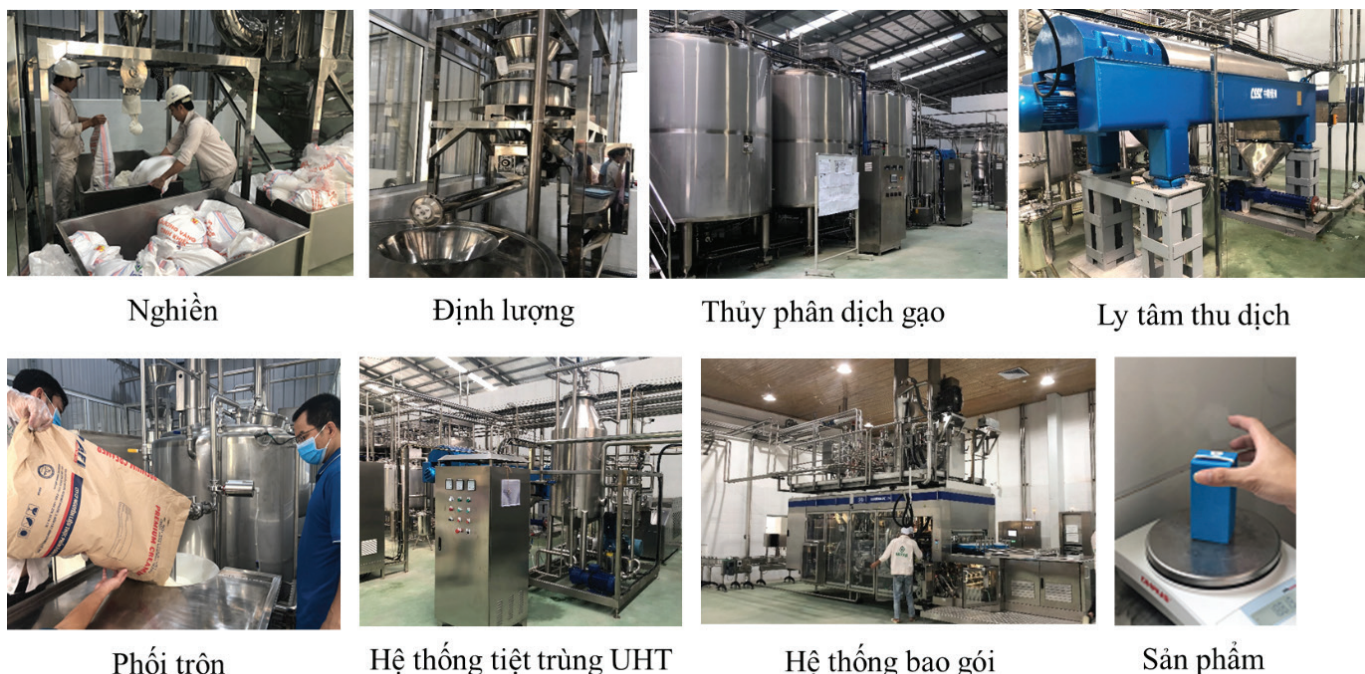
Hình 2. Hệ thống giải pháp thiết bị cho sản xuất sữa gạo với dịch gạo giàu dextrin.
