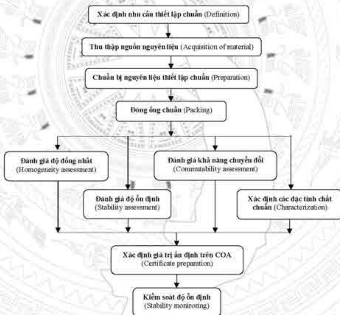
Hình 1.13. Sơ đồ qui trình thiết lập chất chuẩn theo hướng dẫn ISO GUIDE 35 [44]
