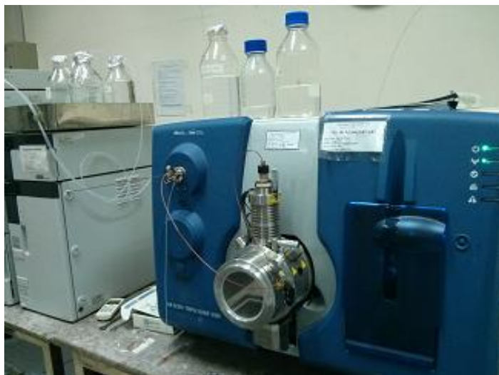
Hình 2.1. Thiết bị sắc ký lỏng khối phổ hai lần sử dụng trong nghiên cứu.
