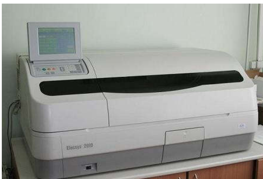
Hình 2.1. Máy xét nghiệm sinh hóa Elecsys 2010 (Roche) (Nguồn: Khoa Sinh hóa, Bệnh viện Trung ương quân đội 108)
