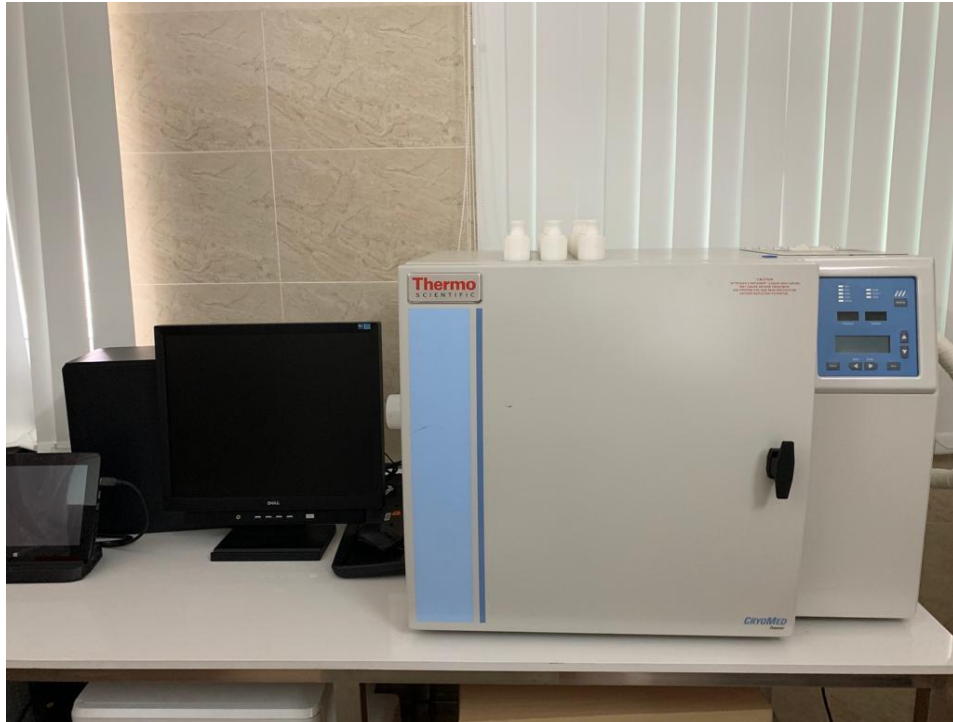
Hình 2.11: Hệ thống hạ nhiệt độ chậm có kiểm soát với ni-tơ lỏng
