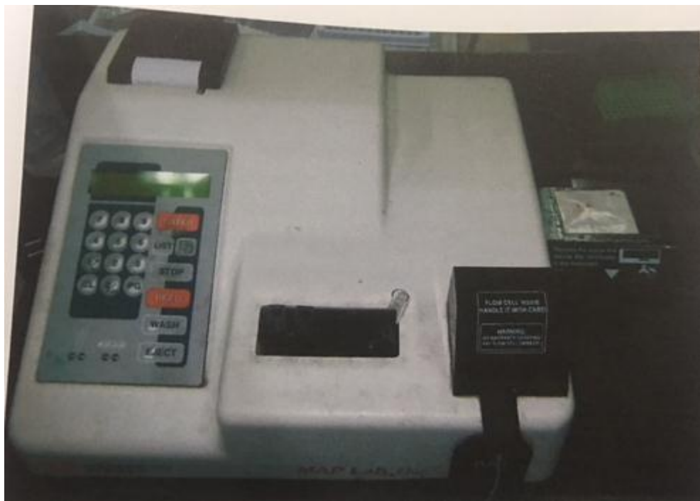
Hình 7: Máy Map Lab Plus dùng để định lượng Lysozyme.
