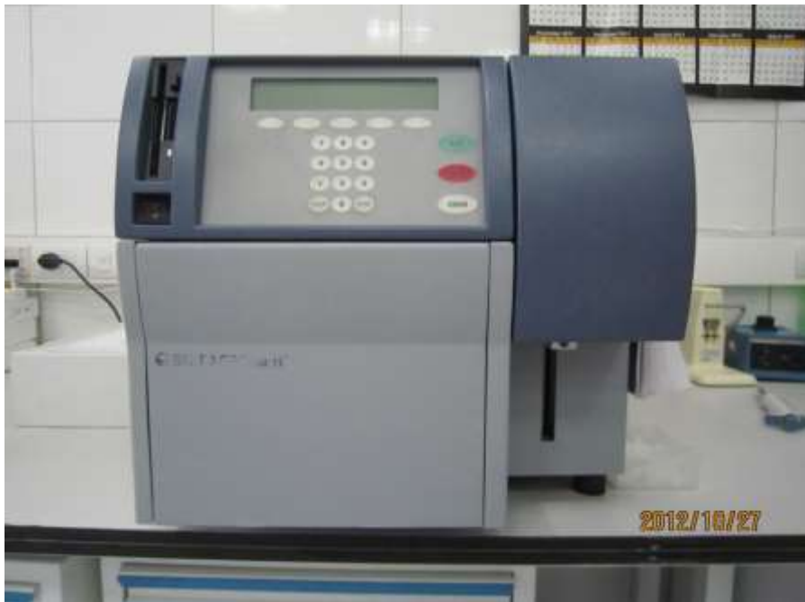
Hình 1. Hệ thống máy đếm dòng tế bào BD FACS Count [nguồn BV Bệnh nhiệt đới QG]
