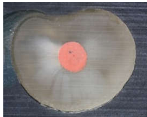
Hình 2.16. Xuất hiện khoảng trống giữa khối vật liệu
