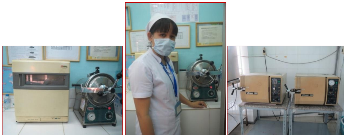
Ảnh 6. Một số dạng lò hấp hơi nước còn sử dụng tại các khoa RHM và khoa KSNK
